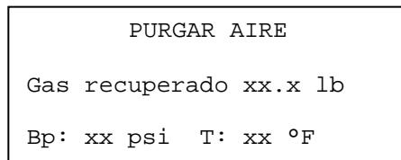
Para purgar los gases no condensables, abra la llave correspondiente hasta que la alarma deje de sonar; cierre la llave.
