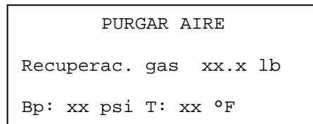
Para purgar los gases no condensables, abra la llave de purga hasta que el mensaje "Purgar aire" deje de parpadear y cierre la llave. La bomba de vacío funcionará momentáneamente para limpiar el circuito de purga de aire.
