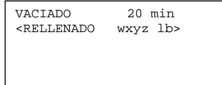
donde “w,yz” se refiere a la cantidad de refrigerante relativa al vehículo seleccionado. La máquina está lista para repostar la cantidad correcta de refrigerante. Confirme con ENTER. *Si desea instalar la BASE AVANZADA DE DATOS (DBA) contacte con el revendedor de la máquina.*
