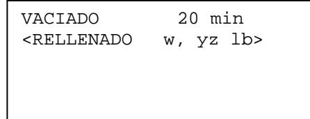
donde “w,yz” se refiere a la cantidad de refrigerante correspondiente al vehículo seleccionado. La máquina está lista para repostar la cantidad correcta de refrigerante. Confirme pulsando ENTER. *Si desea instalar la BASE BÁSICA DE DATOS (DBB), contacte con el revendedor de la máquina.*
